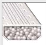
**Aluminiumabstandhalter** sind temperatur-, UV- und alterungsbeständig, nehmen dynamische Belastungen auf und besitzen mit einem längenbezogenen Wärmedurchgangskoeffizienten von 0,064 W/(mK) auch gute Wärmedämmeigenschaften.
