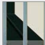
**Condense-Stop** verringert die Kondensatbildung oberhalb der Glasleiste durch einen hochdämmenden Kunststoff-Glas-Abstandhalter. Die „warme Kante“ sorgt für angenehmes Wohnklima durch eine gleichmäßig warme Oberflächentemperatur.
