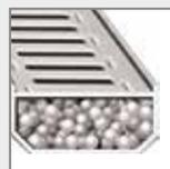
**Edelstahlabstandhalter** bestehen aus besser wärmedämmendem Material mit einem längenbezogenen Wärmedurchgangskoeffizienten von 0,048 W/(mK) bei 3-Scheiben-Wärmeschutzverglasung. Dadurch wird das Risiko der Kondenswasserbildung oberhalb der Glasleiste minimiert.
