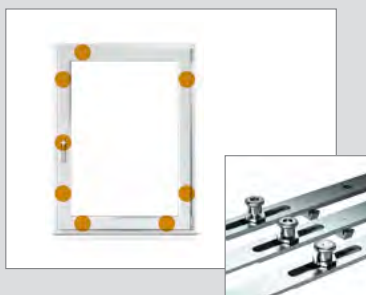
Beschlagsausführung wie bei geprüften Elementen der Sicherheitsklasse RC 2 mit 7 bis 13 Pilzkopfzapfenverriegelungen.
